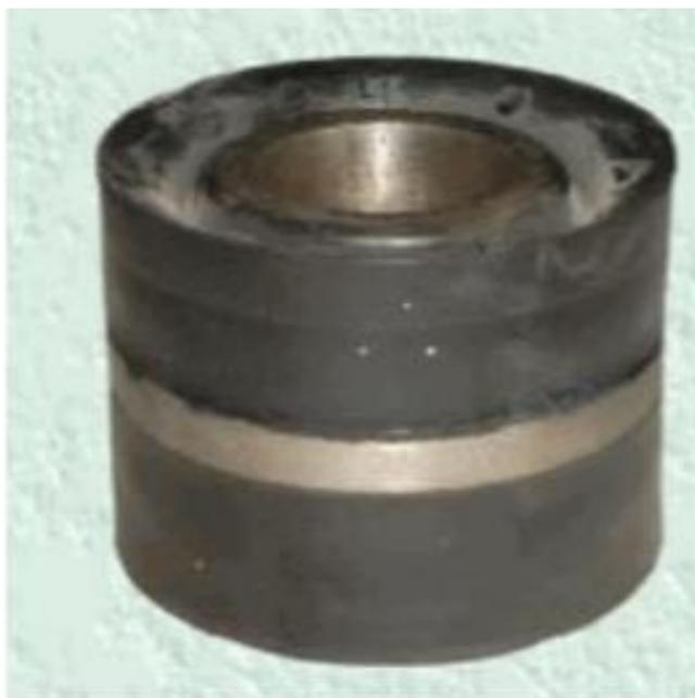
Рисунок 8 – Поршень из резины
